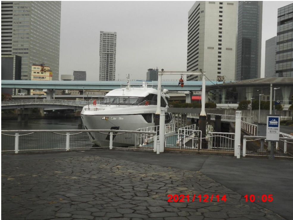
視察船東京みなと丸。全長 35m、幅 7.78m、215 トン、巡航速度 13 ノット (時速 24 km/h)
