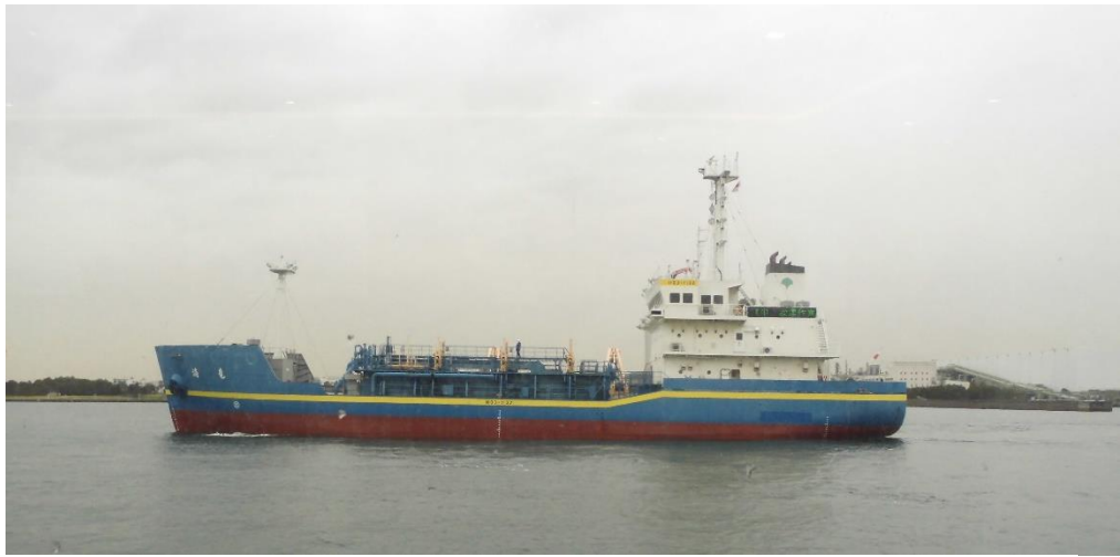
港湾局の浚渫船海竜。海底の土砂を掬う装置の船だそうです。海底にドラムをおいて引っ張って土砂を掬いとる仕組み。
