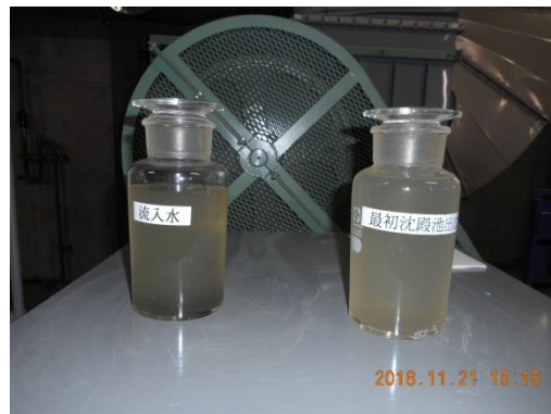
左の瓶の水が流入水の状況。右手の瓶は最初沈殿池から出ていく時の水の状況。すこしにごりが取れています。
