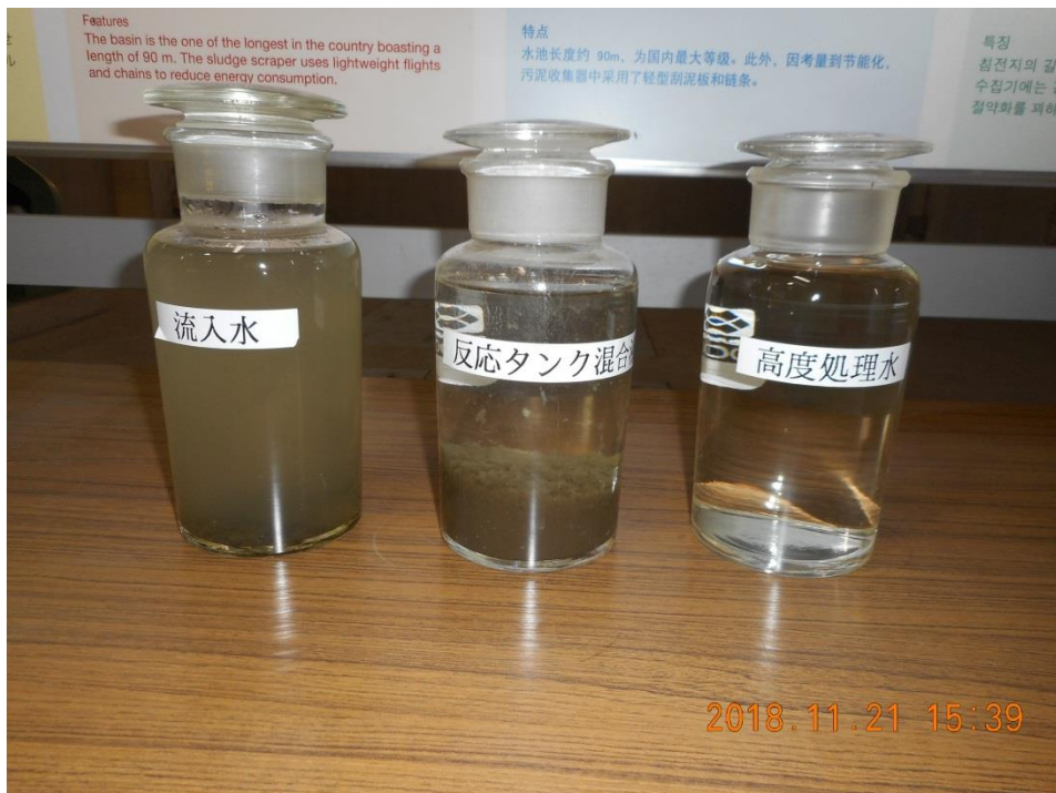
最後の工程の最終沈殿池できれいになった汚水。
